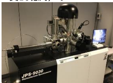
【光電子分光装置】 研究：元素の同時分析や化学状態の把握が可能となり、新たな先端材料の研究開発を実現。
