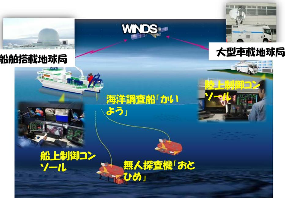
「きずな」を使用した無人探査機遠隔操作実験
