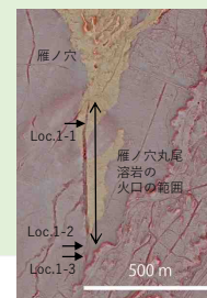
図3 トレンチ調査により推定された雁ノ穴火口範囲
