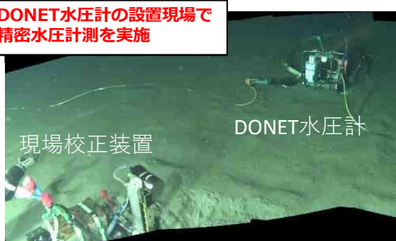
DONETの海底津波計(水圧計)の現場校正
