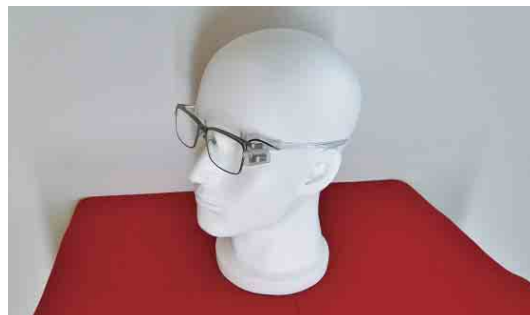
超小型光学エンジンを搭載した眼鏡型ディスプレイ試作品
