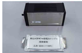
ドライルームレス電池セル生産設備により生産したモジュール
