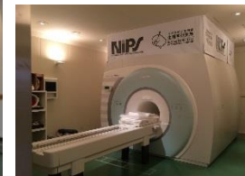
ヒトや実験動物で詳細な計測が可能な7テスラ機能的MRI生理画像解析装置 (fMRI)
