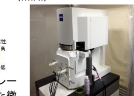
自動切削装置内蔵型の走査型電子顕微鏡。数千枚の連続撮影が可能
