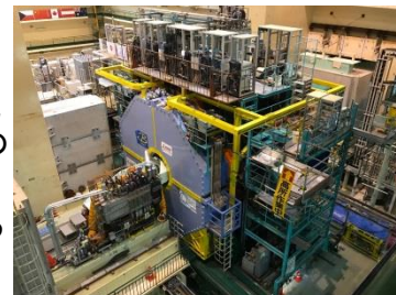
SuperKEKB加速器の衝突点にロールインされたBelle II測定器
