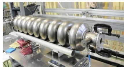
ビーム(粒子の集団)の加速に必要な超伝導加速空洞(長さ約1.3m)の高精度加工
