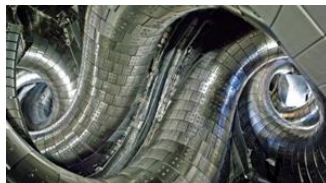
◆大型ヘリカル装置内部の真空容器 体積30立方メートル、温度1億度以上のプラズマを閉じ込める
