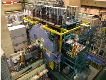
SuperKEKB加速器の衝突点にローリングされたBelle II測定器
