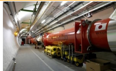
陽子ビームの衝突頻度を上げるために重要な役割を果たすLHCビーム衝突点超伝導電磁石
