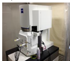
自動切削装置内蔵型の走査型電子顕微鏡。数千枚の連続撮影が可能
