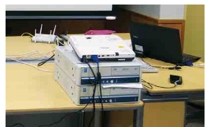
▲同じWeb会議システムがインストールされたPCを2台用意して、障害が発生した際に、すぐに取り換えられるよう備えている
