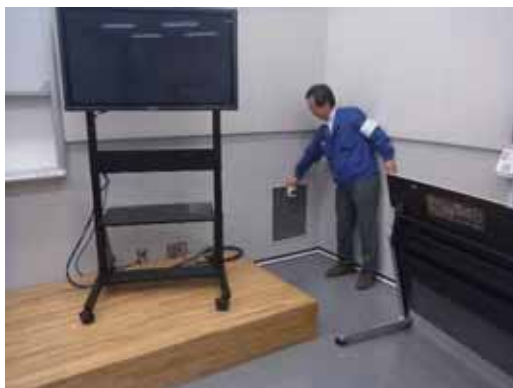
外調機調整のため室内のCO 2 濃度を測定
