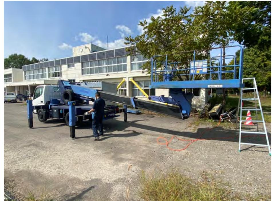
2階建ての場合は10m未満の高所作業車で建物の保守が可能。施設機器のトラブルにより運用が止まることのないよう迅速な対処を行うことが容易である。
