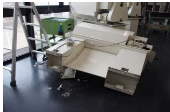
令和3年福島県沖地震により小型精密旋盤が転倒し破損
