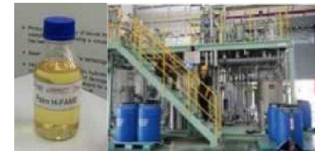
タイ科学技術研究院(TISTR)内に設置されたパイロットプラント(1トン/日規模)とH-FAME燃料。通常の燃料製造施設内に付帯設備として設置可能。
