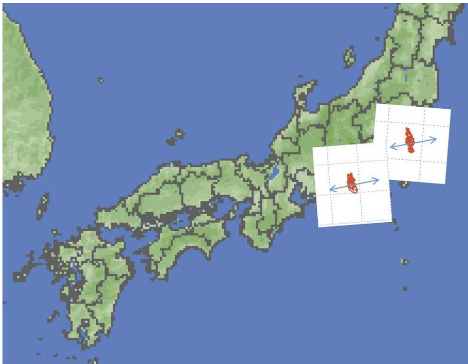
図17. 九州方向から到来したVLF帯パルス電磁波の例(東海大学 [課題番号: 2501]) 2016年4月12日, 及び4月14日のMj6.5前震(21時26分)以前の時刻に, 熊本地震の震央方向から、当該方面に空電がなかったにもかかわらず, VLF帯パルス電磁波が到来した. 例は2016年4月12日15時9分57秒のものである. 偏波からは到来方向に 180^\circ の不確実性が残るが, 着波時刻が1msずれているので西から来たかと判断できる.
