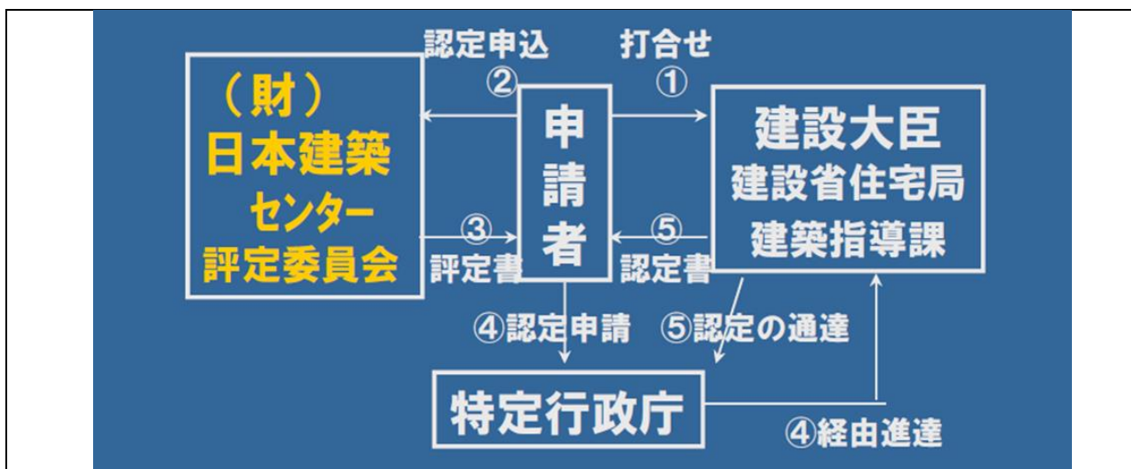
図 3 旧建築基準法第条に基づく認定申請フロー
