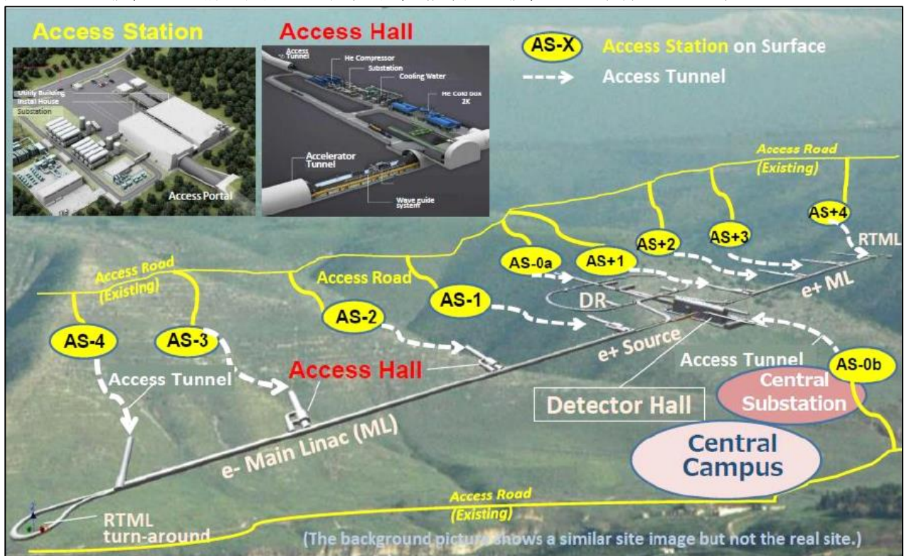
図 1 ILC で設置される構造物及び道路等の配置 (山岳地に設置される場合のイメージ)
