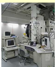
300kV分析型極低温電子顕微鏡 (FEG, He-ステージおよびエネルギーフィルター搭載) に薄膜位相板を挿入。(a)は通常2次元像、(b)はゼルニケ位相差2次元像 (どちらもインフルエンザウイルス (写真は2009年生理学研究所要覧より抜粋))
