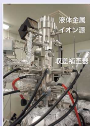
球面収差と色収差を補正する補正収差器を組み込んだ一次イオンカラム
