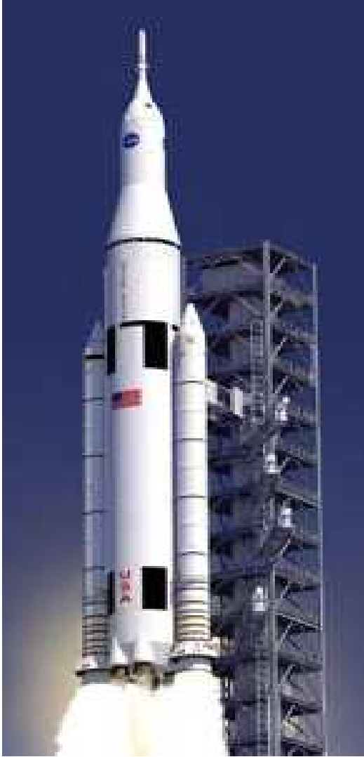
NASA 重量級ロケット(SLS) LEO打上げ能力(70-130t)
