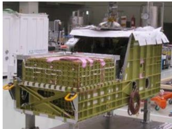
CALET (断熱材を外した状態)
