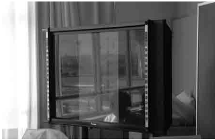
図6 電子黒板の画面が反射している例
