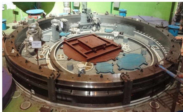
原子炉容器蓋上の大小回転プラグ
