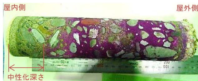
写真2 コンクリートの中酸化深さ
