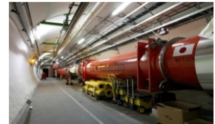
陽子ビームの衝突頻度の向上に重要な役割を果たすLHCビーム衝突点超伝導電磁石
