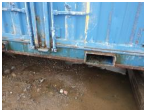
写真2 処理装置の故障によりコンテナから漏れ出す処理水
