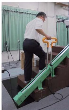
住宅設置型ラックピニオン式電動手すり (住宅設置型試作機)
