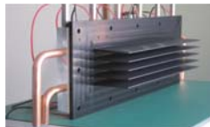
いわき明星大学が開発した熱電変換式温度差発電機
