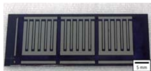
福島大学がインクジェット印刷パターンングにより開発した世界初の次世代太陽電池
