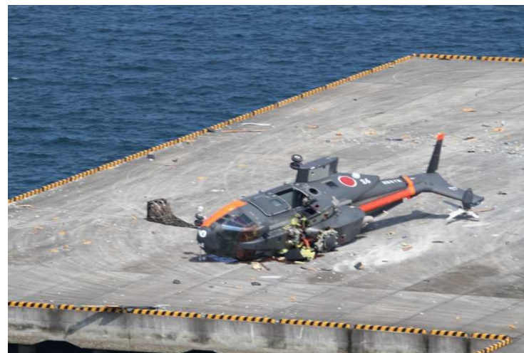
横転した事故機(CH-101)
