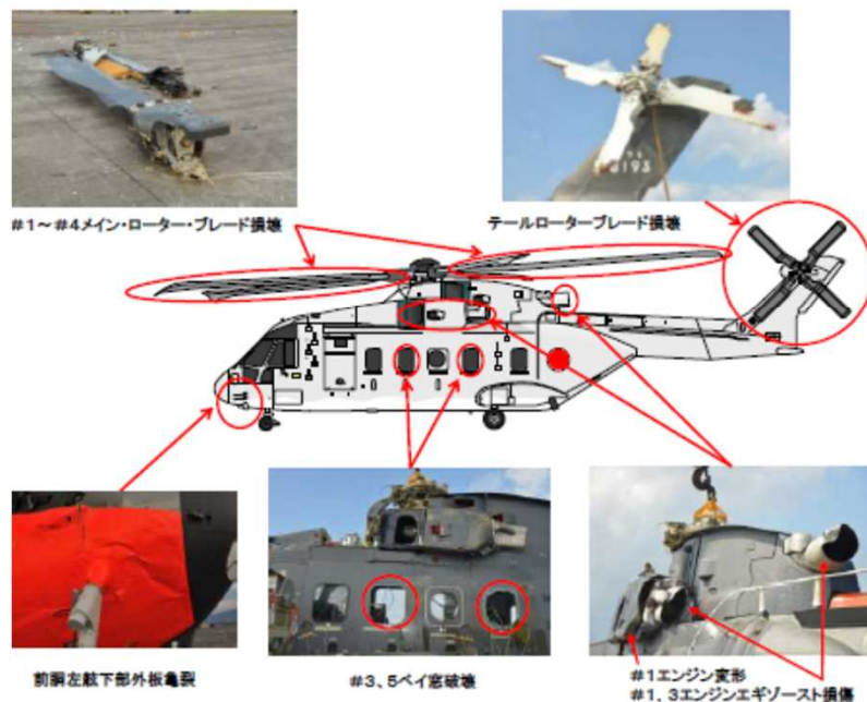
機体の損傷状況(左側)
