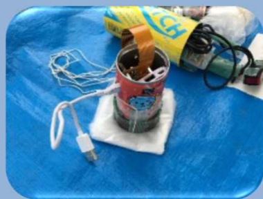
製作された缶サットと係留気球からの投下実験
