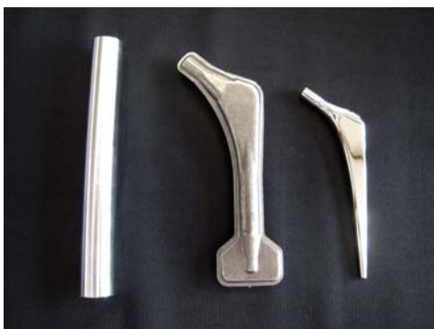
① 人工股関節ステム用丸棒 (写真左) (ステム(写真右)は丸棒より加工)
