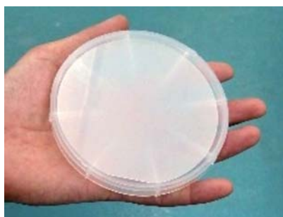
② ミストCVD法による低コストな酸化ガリウムパワー半導体
