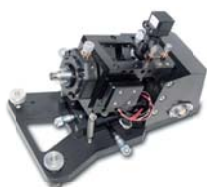
② プローブ走査型高速AFM (生体分子計測研究所より平成27年発売)
