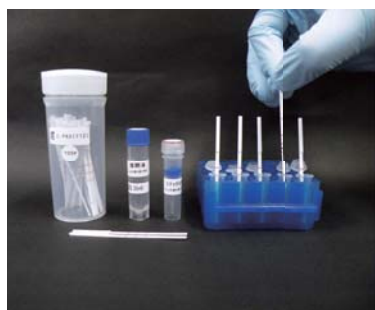
遺伝子検索標準PASキット： 安価・簡便・迅速な感染症 検査ツール
