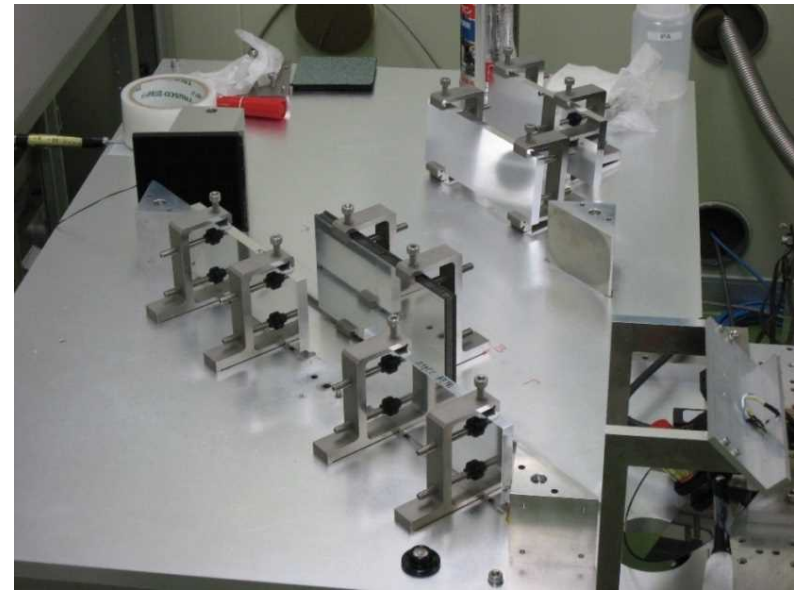
図6. サブミリ波反射率測定の様子。
