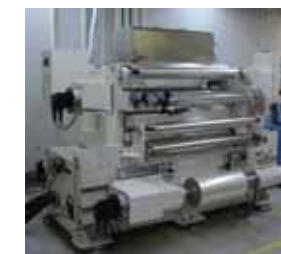
大気圧プラズマCVD法によるDLC連続成膜装置
