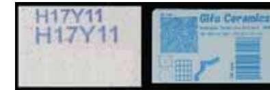
棚板等への直接マーキング印刷(ピエソ方式)
