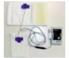
(財)くまもとテクノ産業財団附属電子応用機械技術研究所にて開発中の生活活動度計(A-MES)
