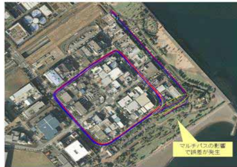
メモリカード型測位受信機を自動車に搭載し、移動体測位実験を実施した結果。良好な軌跡が得られた。
