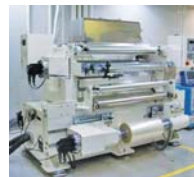
大気圧プラズマCVD法による高周波DLC連続成膜装置
