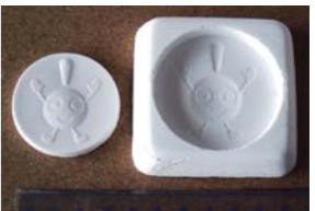
本開発のアルミナ製成形型とそれを用いて作成した薄肉試作品
