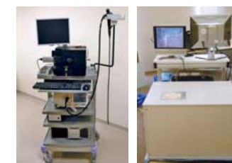
ファイバ仕様ハイパースペクトルカメラ、顕微仕様ハイパースペクトルカメラ
