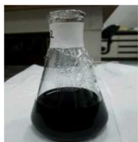
酸化ルテニウムナノシートコロイドの外観と酸化ルテニウムナノシートの原子間力顕微鏡像
