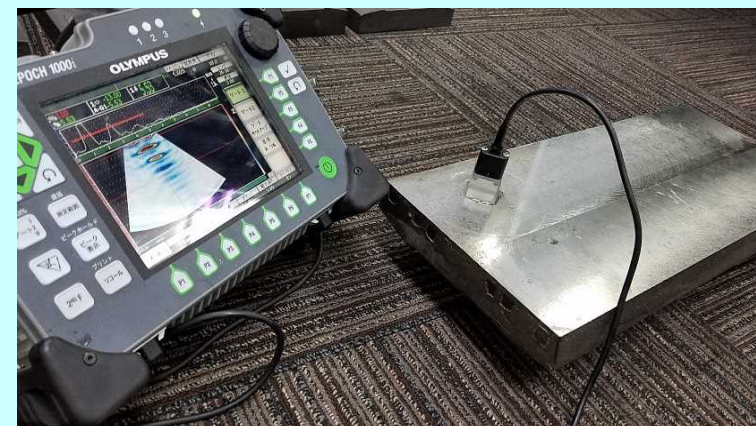
写真2 大学における鑄ぐるみライナーの品質評価(非破壊試験)
