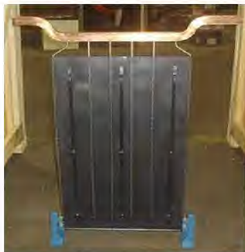
実用化された電解採取用陽極(製品例)
