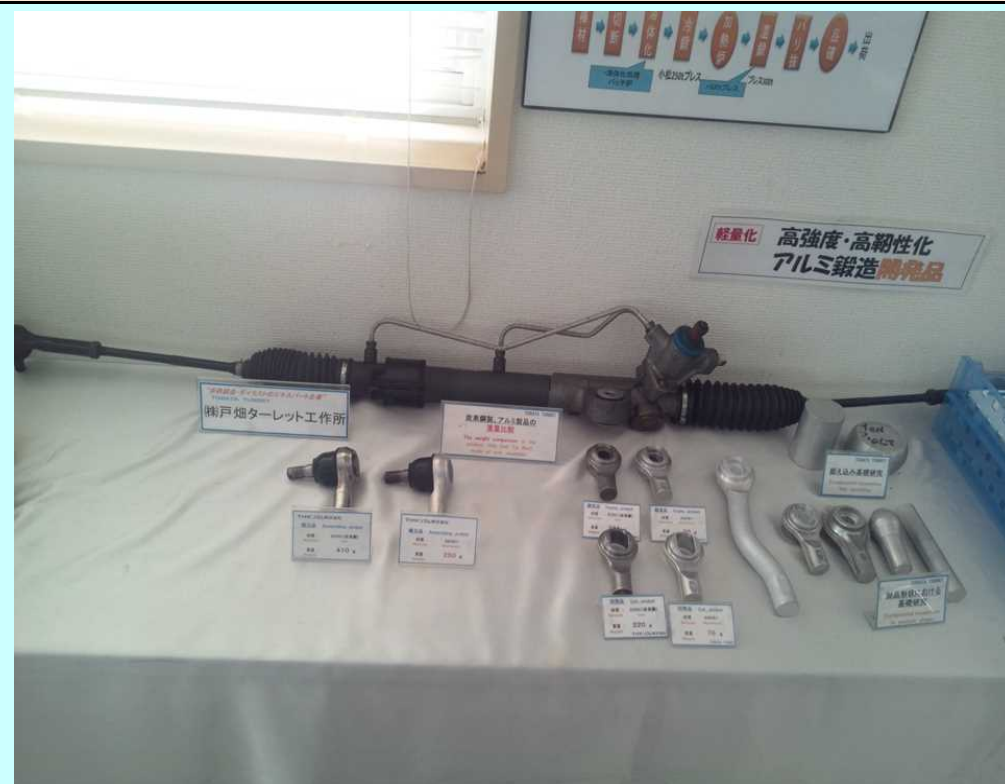
本恒温鍛造成型技術による アルミニウム製タイロッドエンド
