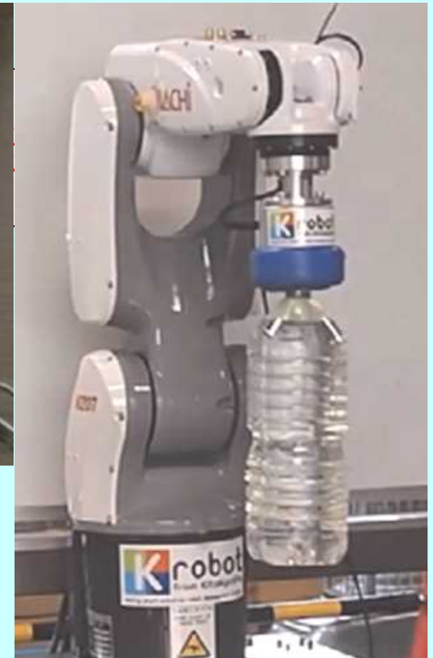
MR \alpha 流体ハンド装備のロボットアーム (ペットボトル把持状態)
