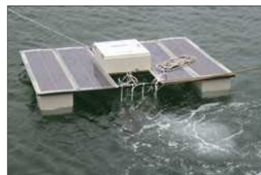
太陽電池を利用した水質改善実験装置
