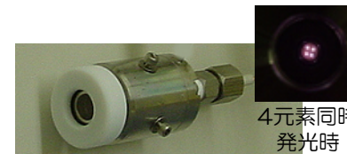
対向型多元素モニター光源 (直径34mm、長さ40mm)
