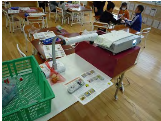
▲ICT機器類を設置しておける専用台。プロジェクタ下のボックスには配線類やリモコンなどを収納できる。
