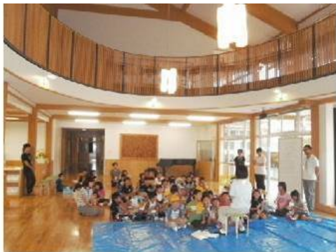
校舎の中央に位置する吹き抜けによる自然換気。天井にはハイサイドライトの自然採光
