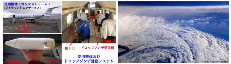
[使用機体及びドロップゾンデ受信システム (左)、台風の目の中 (右)]
