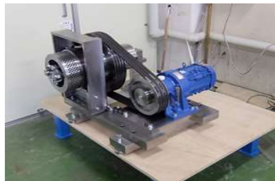
WG5、地元企業との連携で開発試作された RPF 成形機
